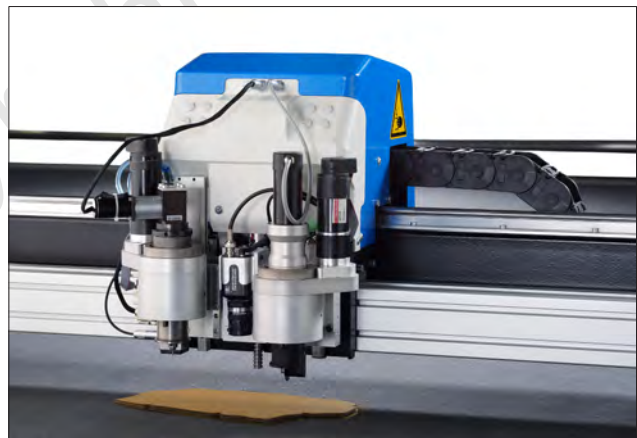
Schneidkopf eines Einzellagencutters. (Fotos: © Bullmer GmbH).
